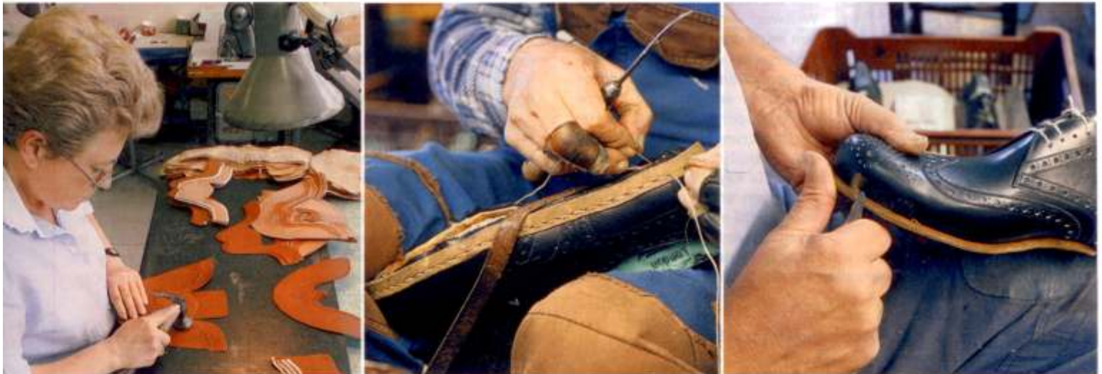
Schritt für Schritt in Handarbeit: Die Profis klopfen den Schaft mit Lyra-Lochung, nähen den Rahmen mit bis zu drei Nähten, schneiden den Sohlenrand (von links nach rechts)
